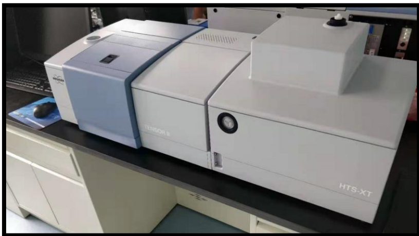
图10研究级傅立叶红外光谱仪 TENSOR II (布鲁克)
