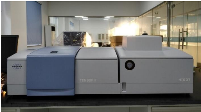
研究级傅立叶红外光谱仪 TENSOR II (布鲁克)
